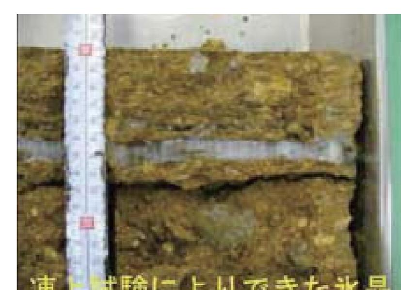
今は、凍上試験により材料を選定して道路の下の地盤を置換しています。
