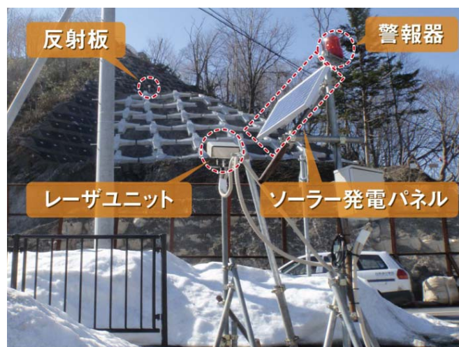
写真-3 拡散レーザ変位計計測システム
