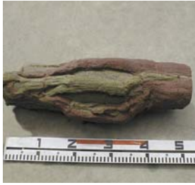
写真 2 繰返し注入による補強体の造成例
