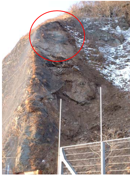
写真 1-2 変成岩地帯の崩壊事例（えりも町）
