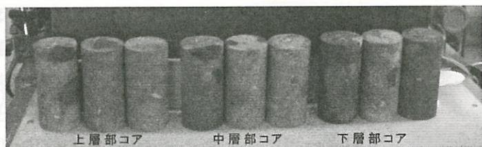
写真-4 巨礫を破碎した改良杭から採取した改良コア状況
