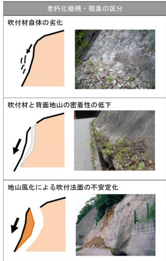
図-2 老朽化機構の区分<sup>2)</sup>
