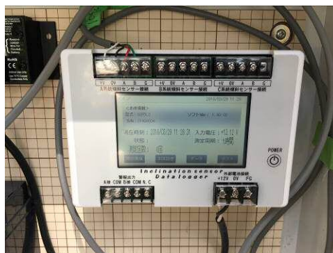
写真-1 パイプ傾斜計とロガー設置状況
