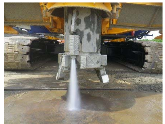
写真-3 エジェクター装置 (エアと水を混合して噴射する装置)
