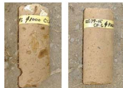
写真-6 従来式とエジェクター式のコアの比較
