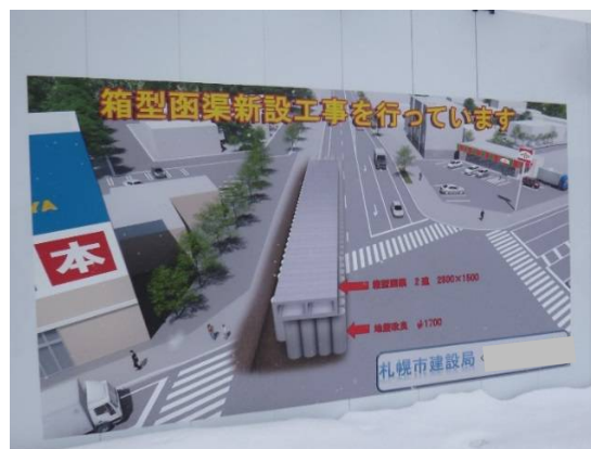
図-2 箱型函渠設置イメージ図
