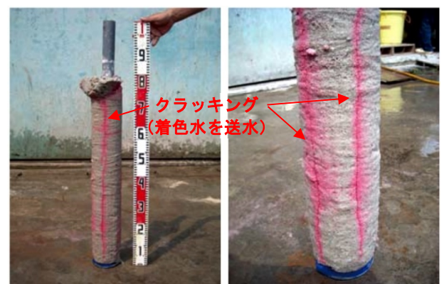
写真-3 シール材に発生した縦方向クラッキング
