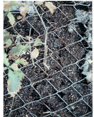
写真-1 ラス金網によって損傷した植物根状況
