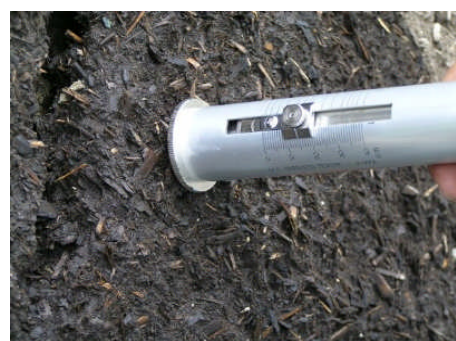
写真-2 土壌硬度測定状況
