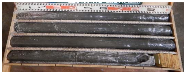
写真3 全長ボーリングにより採取した改良体 表3 一軸圧縮強さと変動係数
