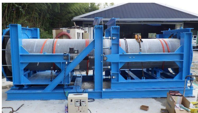
写真－8 耐震試験装置
