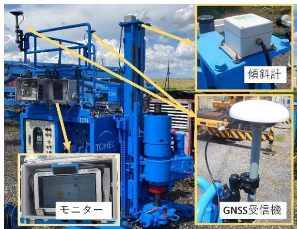
写真 1 改良機 GNSS 装着状況
