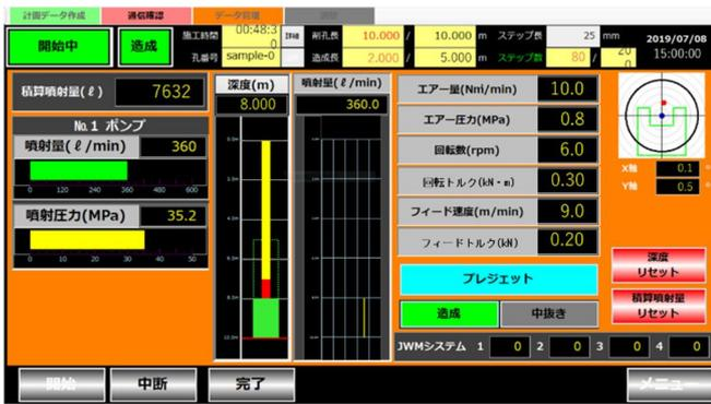
図 11 施工管理装置表示例（標準表示）
