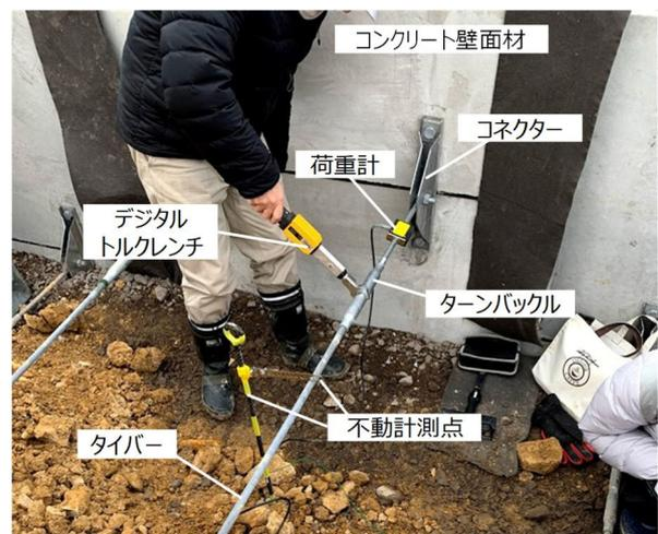
写真-4 施工中の補強土壁で実施した試験の様子
