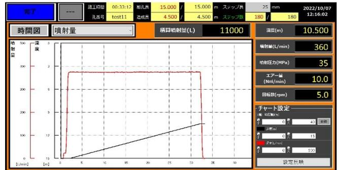
図 12 施工管理装置表示例（経時変化表示）
