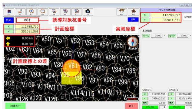
図 2 平面位置誘導システム表示例
