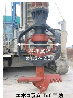
複合相対型攪拌工法の外観
