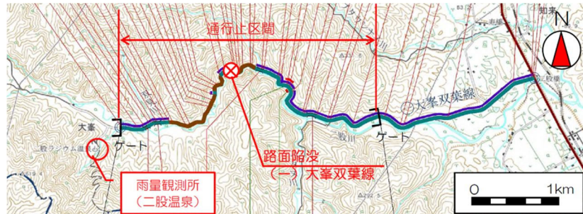
図-1 大峯双葉線における路面陥没箇所（国土地理院「地理院地図」 2) を用いて作図）
