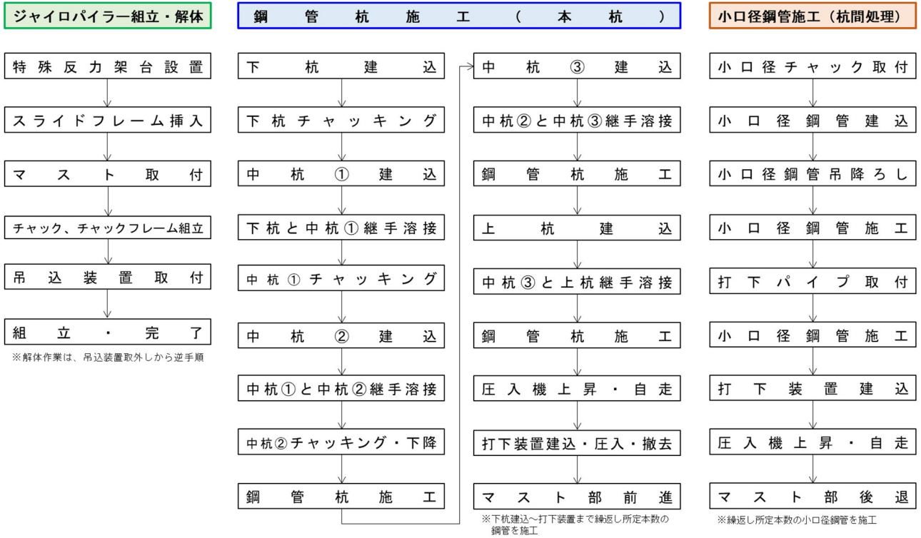
図-18 施工フロー図（ジャイロパイラー™組立・解体、鋼管杭施工、小口径鋼管施工）
