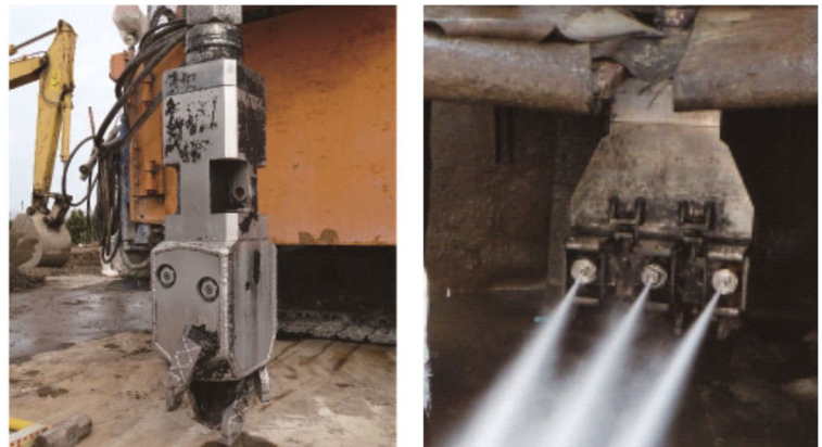
図-8 FTJ-FAN 工法 攪拌翼 (左図：扇形改良用、右図：矩形改良用)
