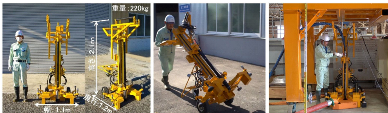
図-11 Mole Eco Jet 工法（左図：施工機械、中図：運搬イメージ、右図：施工イメージ）
