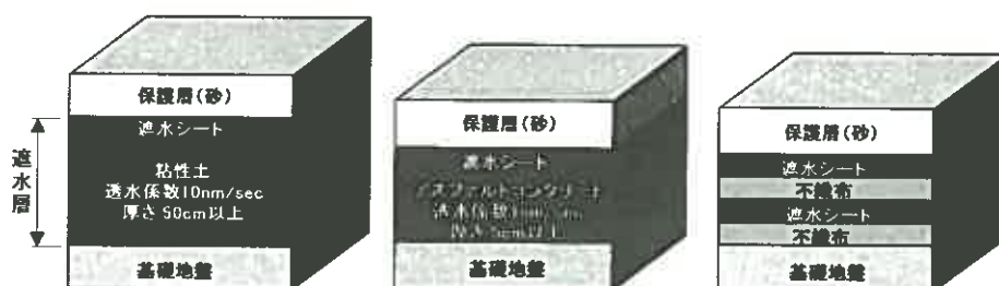
図－4 遮水工詳細図
