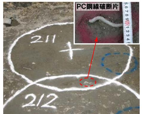
写真-6 改良体ラップ部の改良体断面
