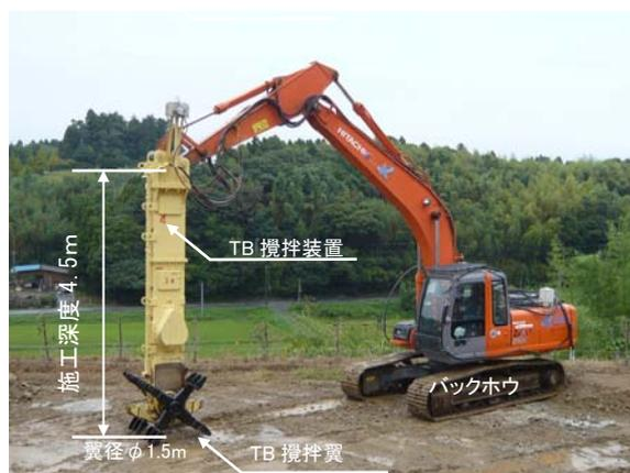
写真-3 TB-S型施工機
